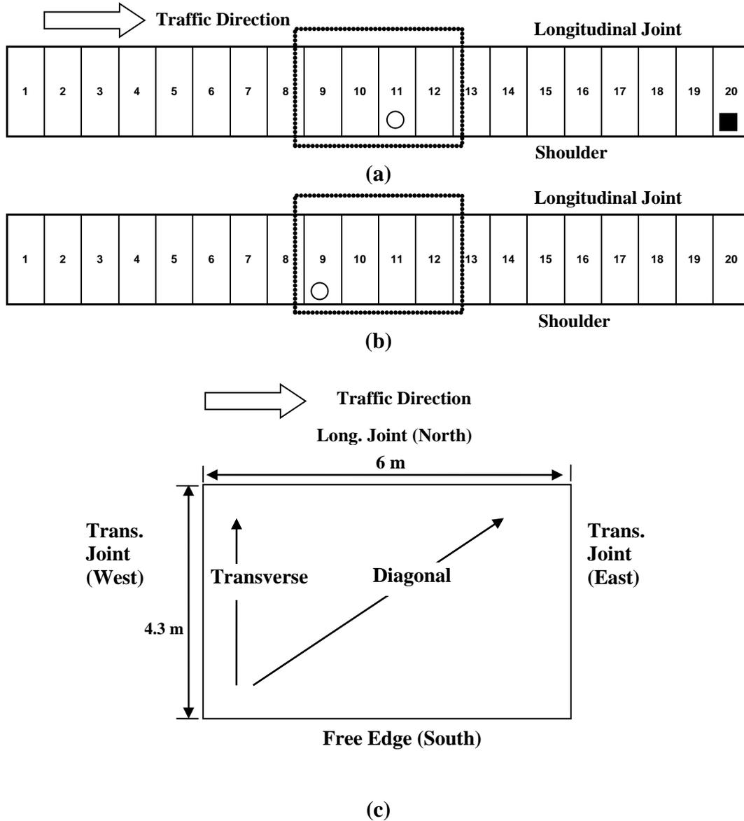
Legend : ○ - Thermochron I-Buttons<sup>®</sup> instrumentation location
